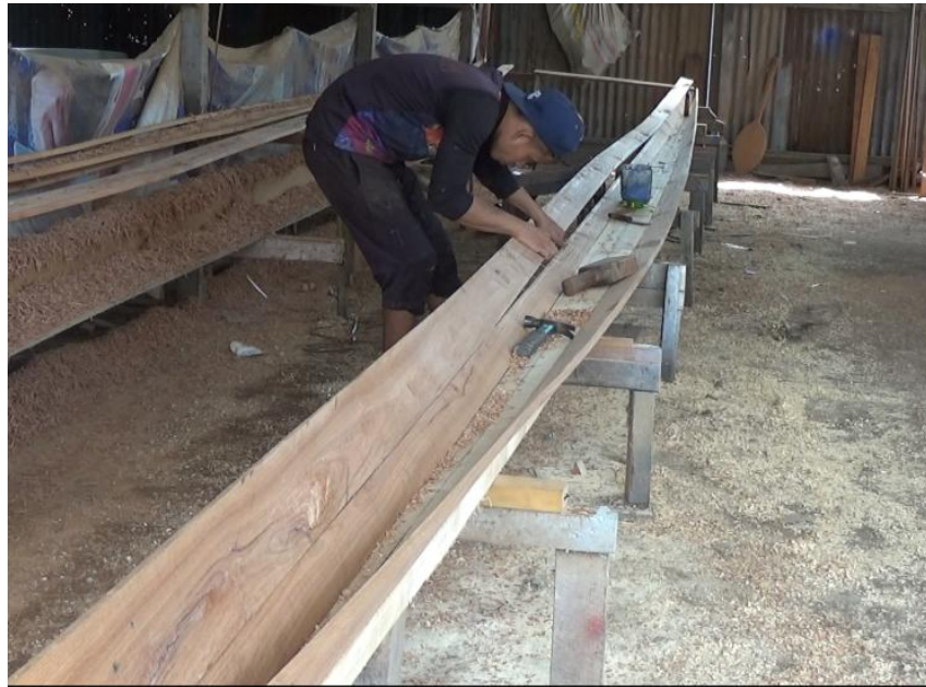
Gambar 2. Proses pembuatan sampan bidar
